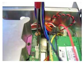
Entfernen Sie jetzt noch das USB Kabel und die Power/LED Kabel
