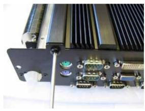
Befestigen Sie die Abdeckung der Heatpipe
