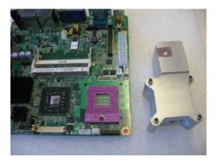
Legen Sie die CPU ein (die CPU passt nur in eine Richtung drauf)
