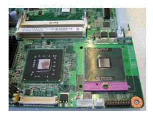
Befestigen Sie die CPU an der Abgebildeten Schraube
