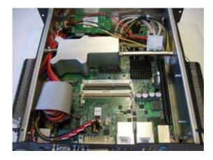
Fangen Sie nun an die Heatpipe abzuschrauben, diese ist an den folgenden 2 Schrauben befestigt (VORSICHT! Die Endstücke sind unterschiedlich lang)
